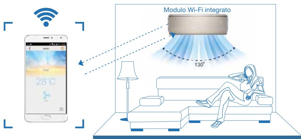
Lo smartphone può essere collegato direttamente al climatizzatore tramite tecnologia Wi-Fi Direct, senza l'ausilio di un router. Questa soluzione può essere selezionata a casa per il controllo da breve distanza.
